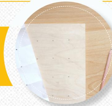
Zunächst müssen die Stellen auf dem Brett, an denen die Löcher gebohrt werden sollen, markiert werden. Die Abstände zwischen den Löchern sollen in etwa so groß sein wie eine Katzenpfote. Tipp: Papier erst längs und dann quer (wie einen Fächer) falten und die Stellen, an denen sich die Falten kreuzen, markieren – schon hat man eine Schablone für die Bohrlöcher!
