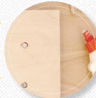
Wenn alle Löcher gebohrt sind, Brett mit Schleifpapier abschleifen. In jedes Loch ein wenig Holzleim geben und Dübel in die Löcher drücken. Zum Schluss alle Dübel mit einem Hammer noch einmal festklopfen und trocknen lassen.
